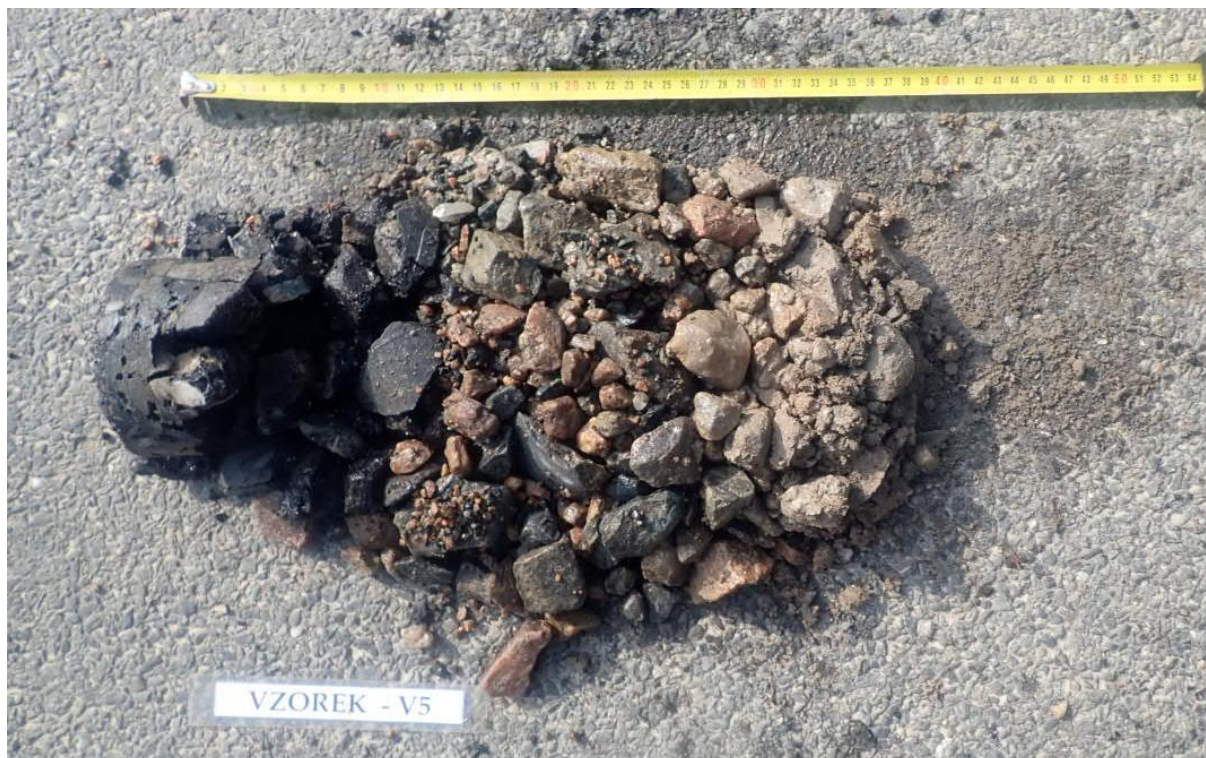
Obr. 9 - Jádro výtvetu Vzorek – V5 (in situ).
