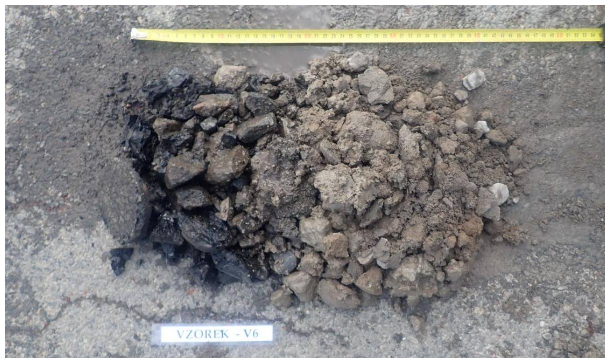
Obr. 11 - Jádru vývrtu Vzorek – V6 (in situ).
