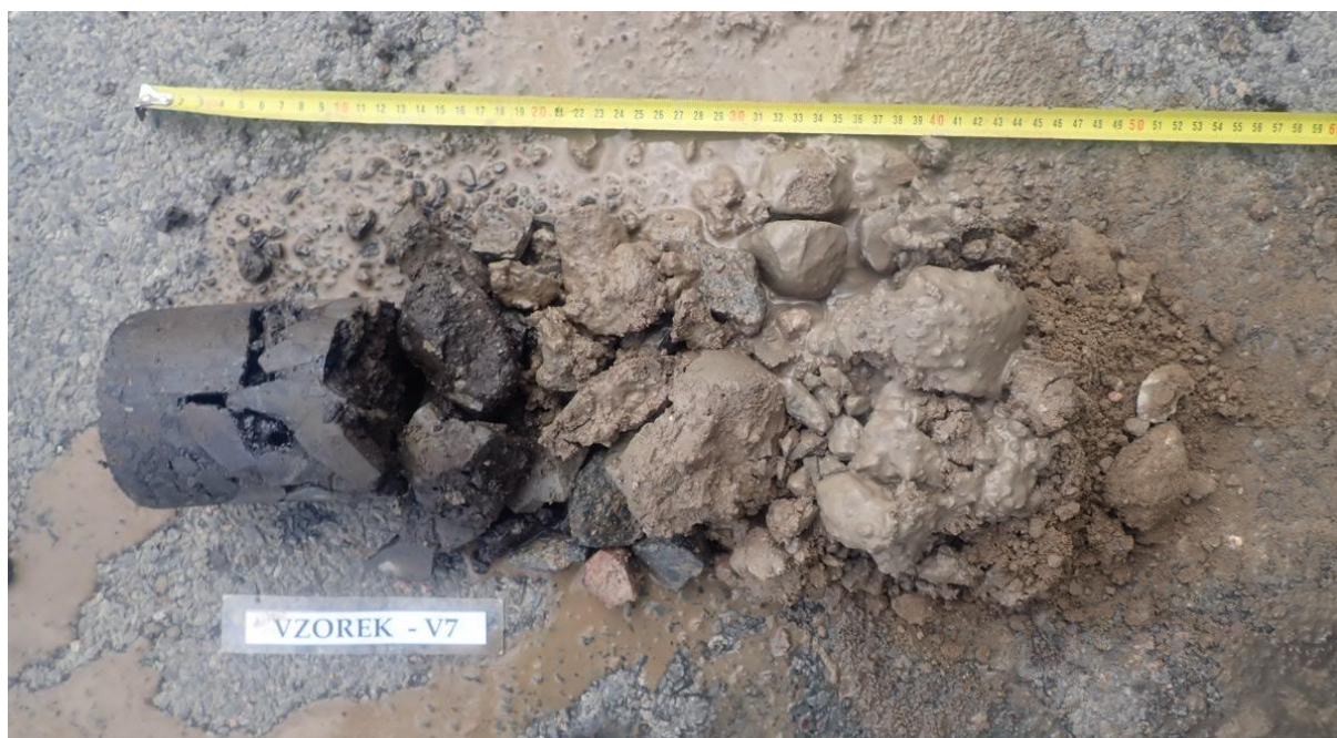
Obr. 13 - Jádro vývrtu Vzorek – V7 (in situ).
