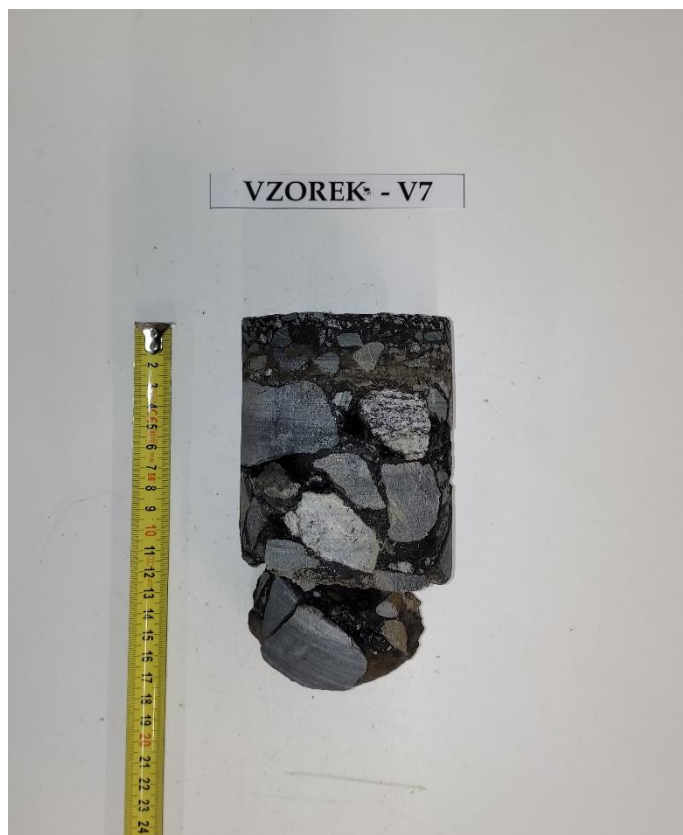
Obr. 14 - Jádru vývrtu Vzorek – V7 (laboratoř).
