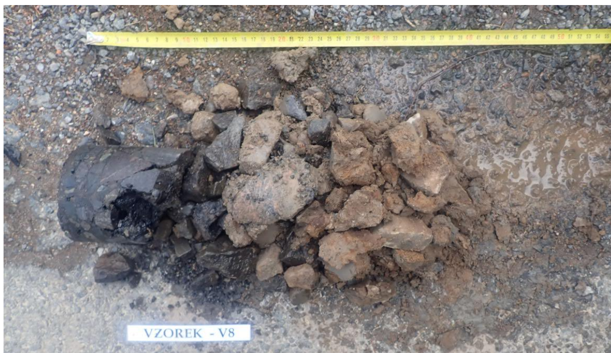
Obr. 15 - Jádro vývrtu Vzorek – V8 (in situ).
