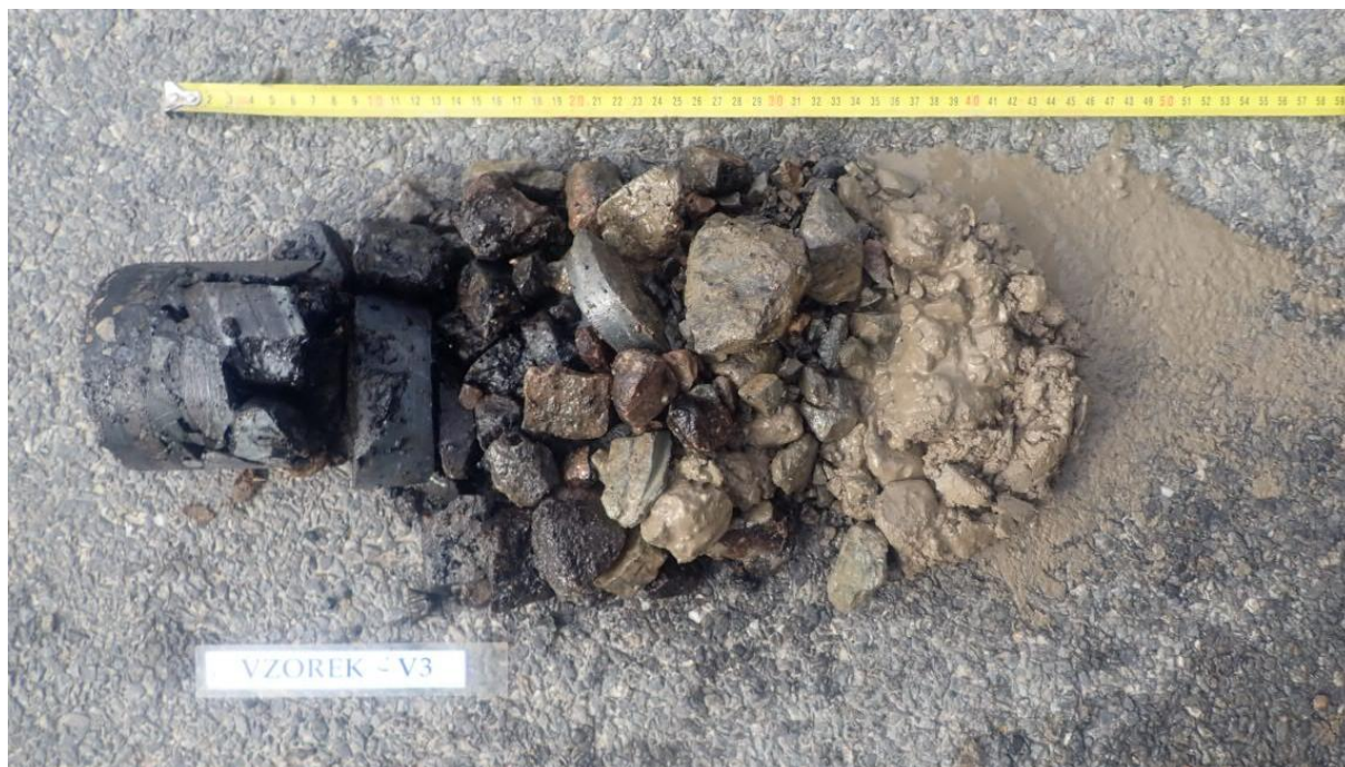
Obr. 5 - Jádro výtvtu Vzorek – V3 (in situ).
