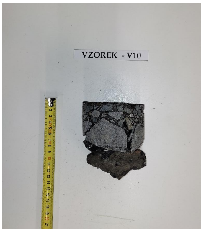
Obr. 20 - Jádro vývrtu Vzorek – V10 (laboratoř).
