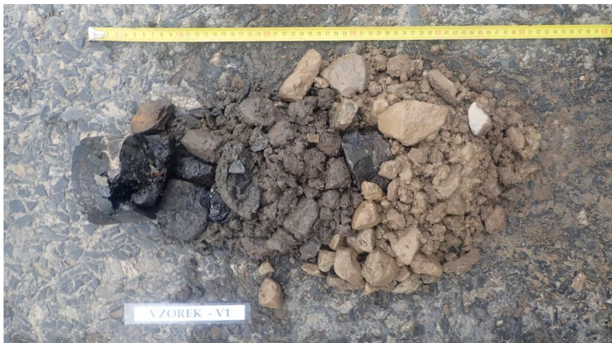
Obr. 1 - Jádro vývrtu Vzorek – V1 (in situ).
