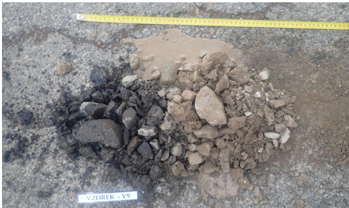
Obr. 17 - Jádro vývrtu Vzorek – V9 (in situ).
