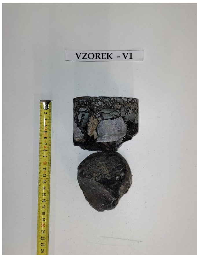
Obr. 2 - Jádru vývrtu Vzorek – V1 (laboratoř).
