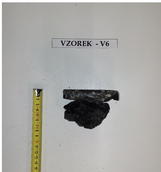
Obr. 12 - Jádro vývrtu Vzorek – V6 (laboratoř).
