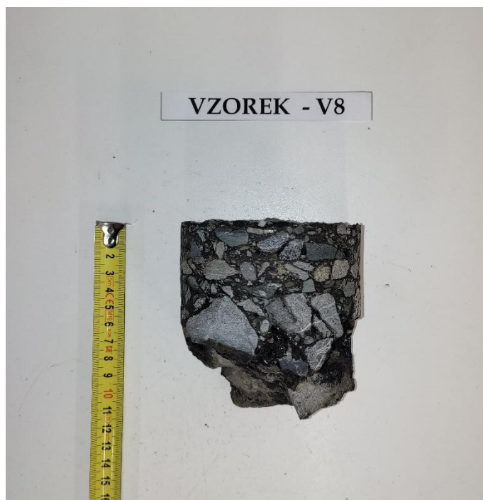
Obr. 16 - Jádro vývrtu Vzorek – V8 (laboratoř).
