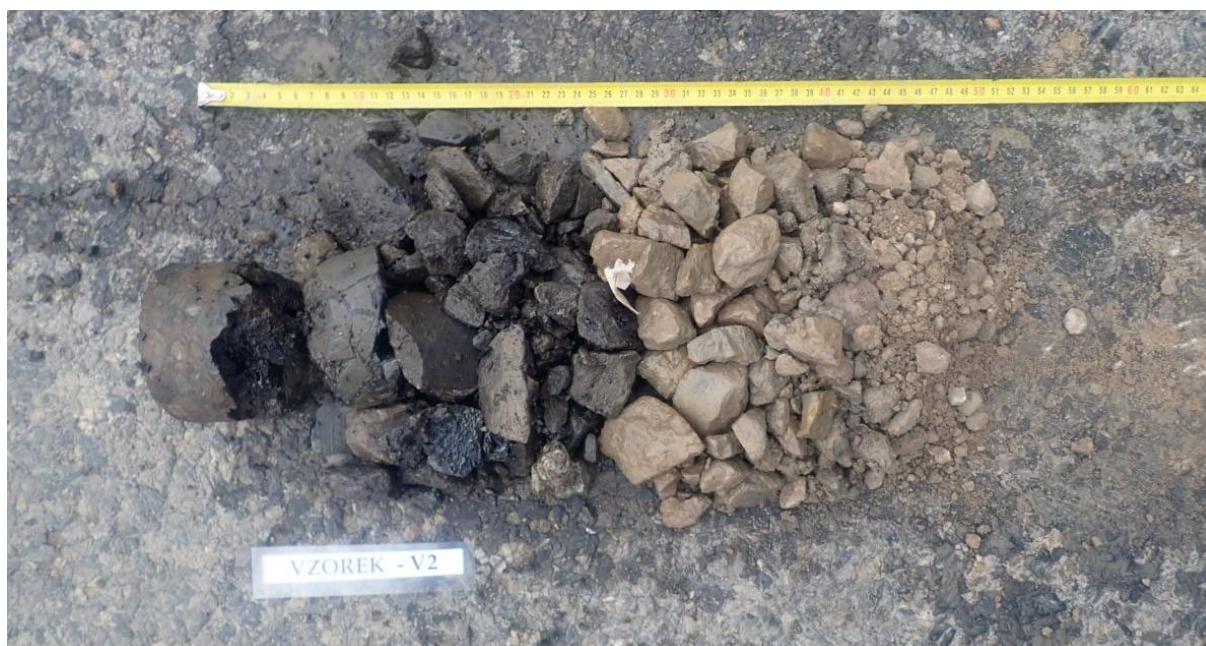
Obr. 3 - Jádro vývrtu Vzorek – V2 (in situ).
