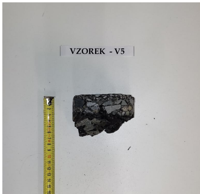
Obr. 10 - Jádro vývrtu Vzorek – V5 (laboratoř).
