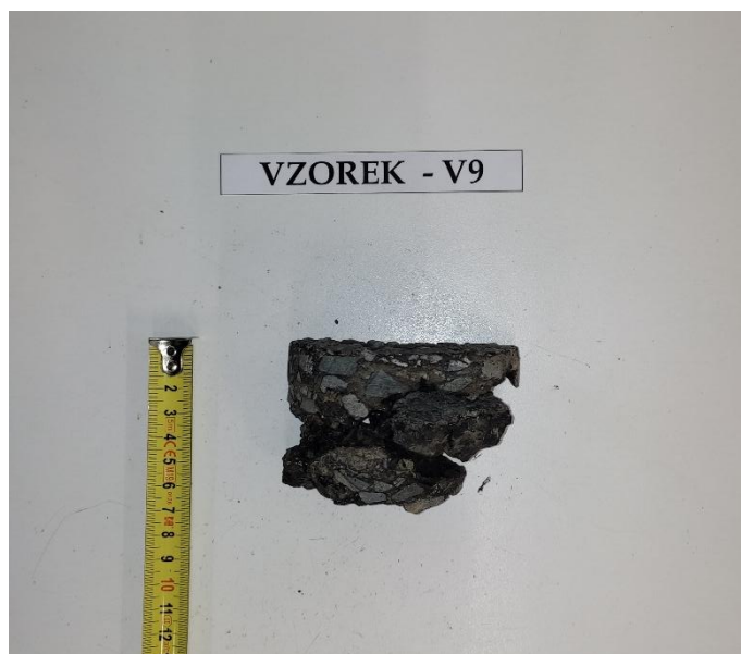
Obr. 18 - Jádro vývrtu Vzorek – V9 (laboratoř).
